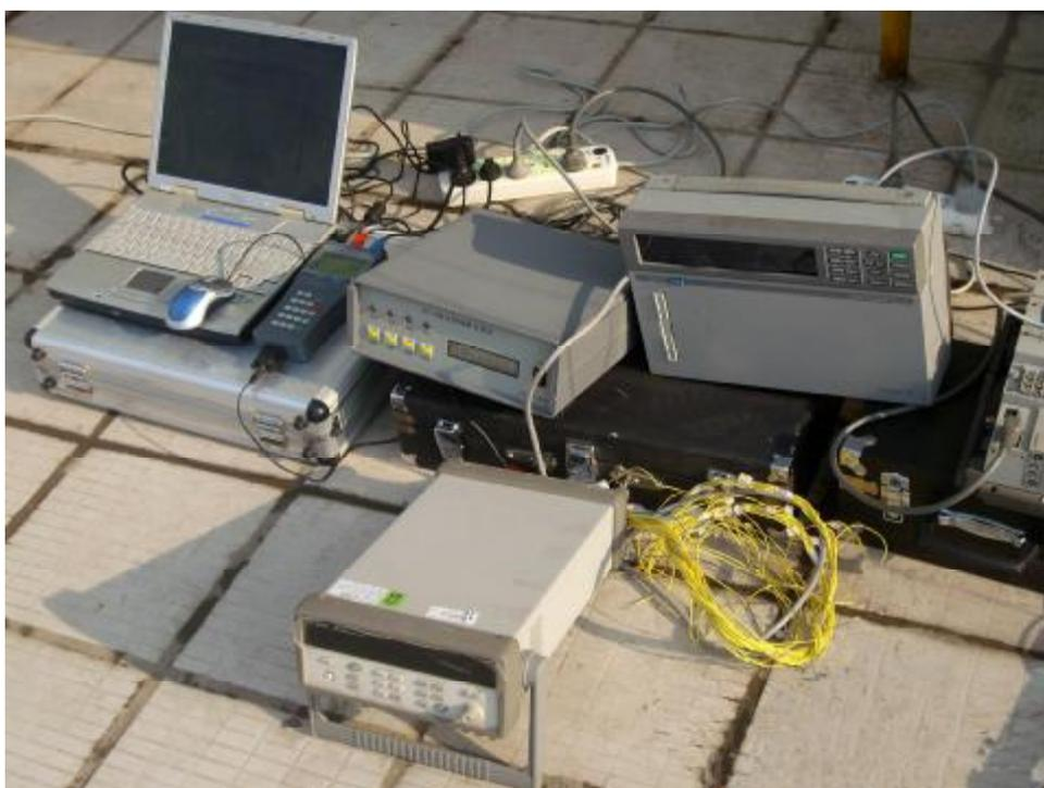
太阳辐照量、贮热水箱温度数据采集仪器
