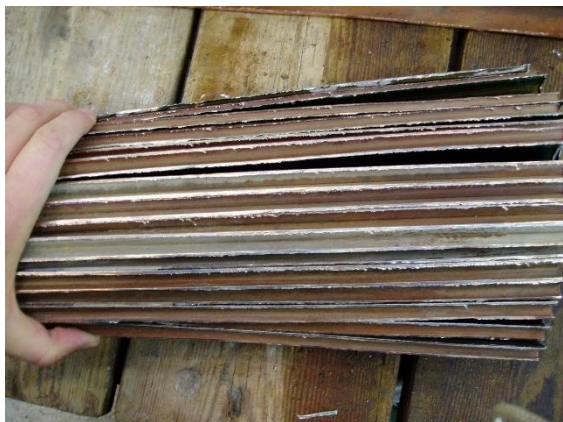
Ottrupgård集热器靠近集热器出口下半部流道照片
