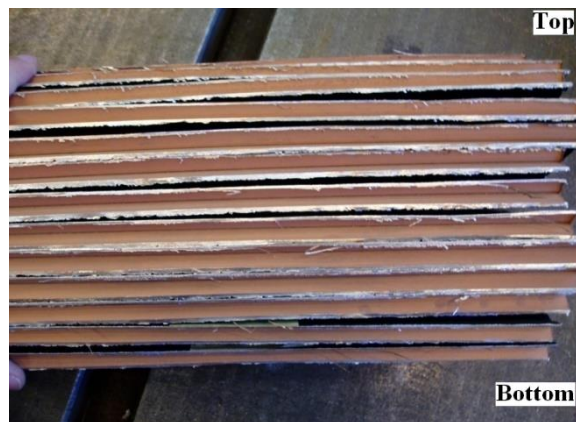
Marstal集热器进口侧下半部流道照片
