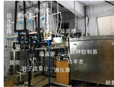
(a)电加热棒模拟地埋管换热器砂箱实验装置
