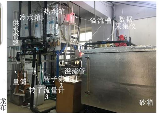
(b)地埋管换热器砂箱实验装置
